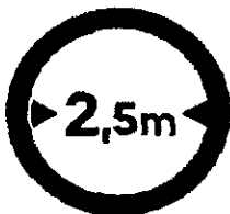
Signalisation avancée d'une direction interdite aux véhicules dont la largeur, chargement compris, est supérieure au nombre indiqué
