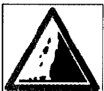
A19 : Risque de chute de pierres
